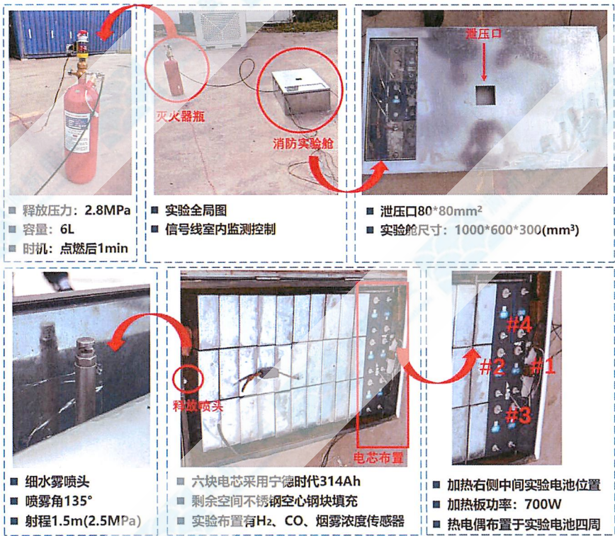
图 2 磷酸铁锂电池灭火试验模型图
